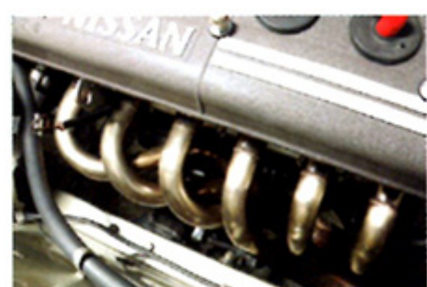
エキゾーストパイプは純正に替えてステンレス製にされている。
