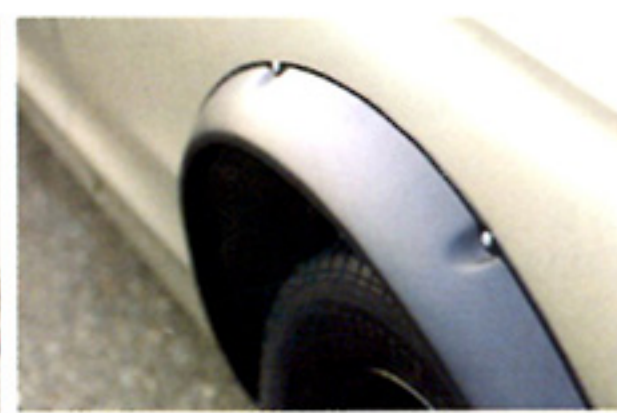
リアにだけブラックのオーバーフェンダーが装着される、ハードトップGT-R。ワイドタイヤの装着を前提としていた。
