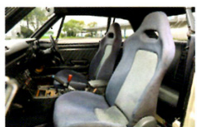
フロントにはR32用のモノフォルムバケットシートを装着。
