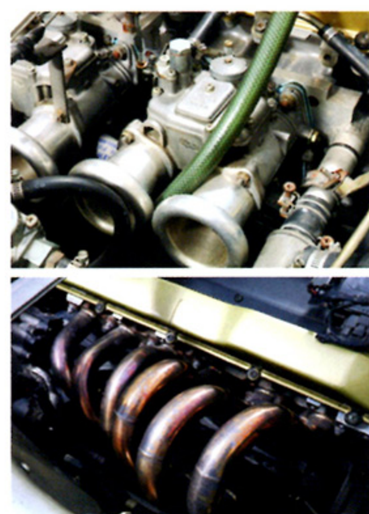
RB25エンジンにキャブを組み合わせ、エキゾーストパイプはロッキオートオリジナルのステンレス製を装着。効率アップを図っている。
